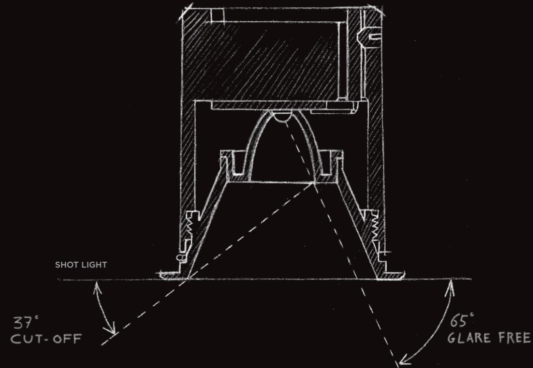
GRACIAS A UN REFLECTOR ESPECÍFICAMENTE DISEÑADO, LOS RAYOS DE LUZ NO BAÑAN LA LUMINARIA Y SE ENCAUZAN DIRECTAMENTE AL EXTERIOR SIN TOCAR LA PANTALLA. POR ELLO, EL EFECTO 'THE INVISIBLE BLACK' HACE QUE, ENCENDIDA O APAGADA, LA LUMINARIA CONSERVE SIEMPRE LA MISMA APARIENCIA. EL ORIGEN DE LA LUZ NO SE APRECIA DESDE PRÁCTICAMENTE NINGUNA POSICIÓN NATURAL DEL OBSERVADOR, EL DESLUMBRAMIENTO SE ELIMINA Y EL CONFORT VISUAL ES MÁXIMO.
